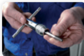
3- placer l'extracteur sur tourne à gauche, ou mieux, un porte-outils à cliquet
