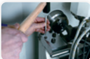
MODE D'EMPLOI 1- marquer le centre avec pointeau et marteau
