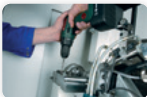
2- percer au centre du gougeon cassé, idéalement avec un foret conique adapté
