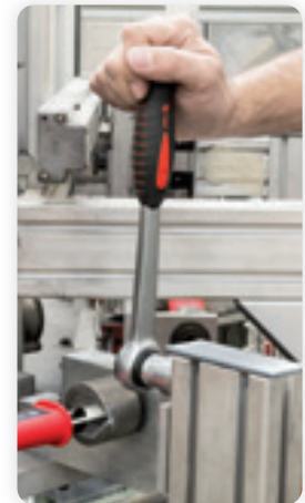
Saisie en extrémité du manche grâce à sa forme sphérique.
