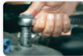
Liaison corps-manche du cliquet étudiée pour ne pas gêner la main lors de la prise.
